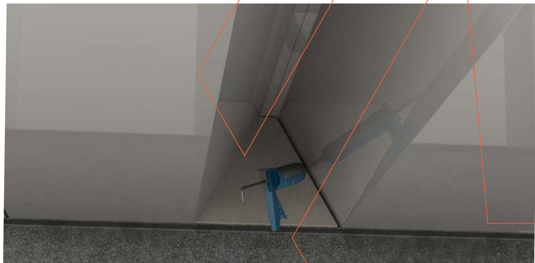
4- Los triángulos se colocan en posición vertical u horizontal, según sea la necesidad. siempre entre la viga y el panel.
